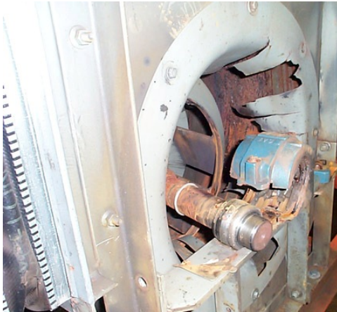
风扇和电机的轴承故障可以通过测量其振动值得以避免
