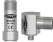
Sensor de ultrasonido IEPE de vibración dinámica, montaje 1/4-28, conector mini-MIL de 2 pines, 100 mV/g, ±10 % ±80 g, rango dinámico, pico
