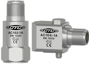
Acelerómetro multipropósito, conector de 2 pines, 100 mV/g, ±10 % ±80 g, rango dinámico, pico
