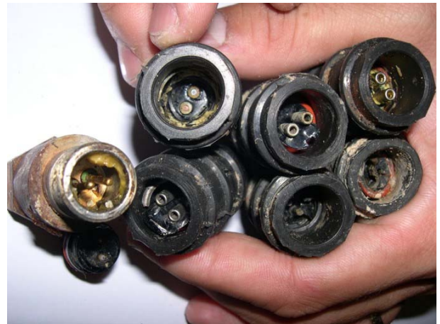
图#9 – 满手的接头问题
