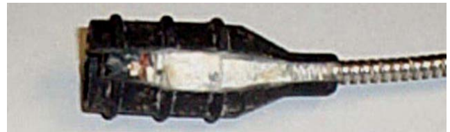
图 #4 - 铝核心的接头
