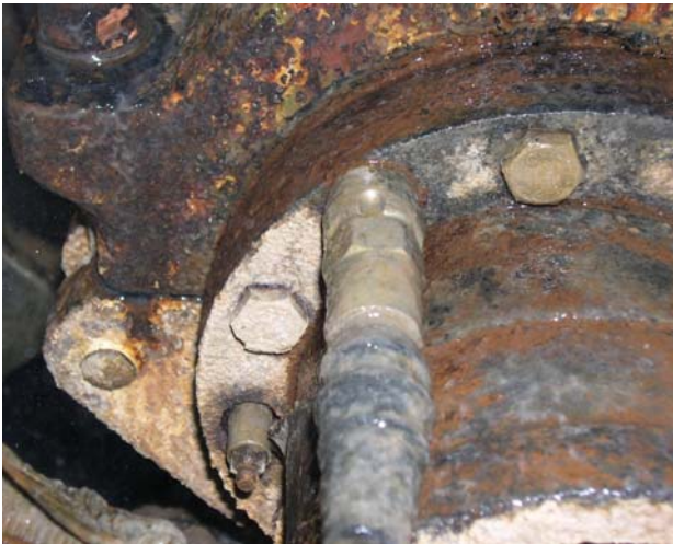
图#1 - 加速度振动传感器和接头
